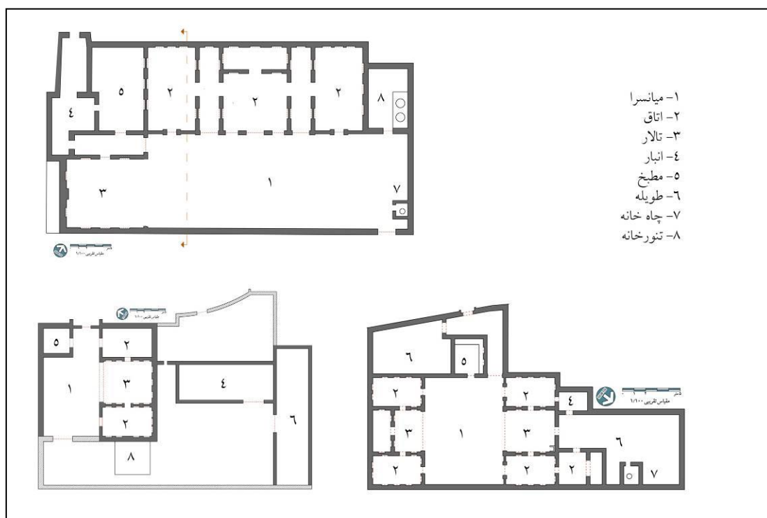
تصویر ۸. عناصر و اجزای اصلی خانه‌های روستایی در نواحی گرم و خشک با توجه به تنوع در الگوی ساخت (مأخذ: ریاحی، ۱۳۸۷)
