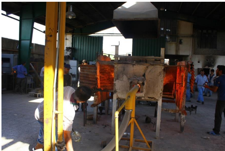
شکل ۲. نمایی از کوره ذوب مجدد شیشه - کوره تو یا تاباندن - در کارخانه شیشه الوان بلور (نگارنده)
