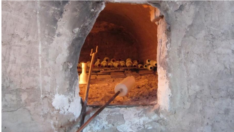
شکل ۳. کوره تنشزدایی یا گرمخانه سنتی (نگارنده)
